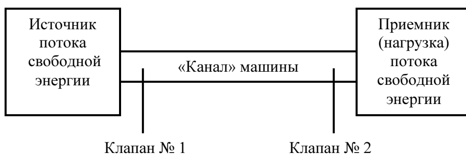
Рис. 22.2. «Обобщенная» машина как «канал», соединяющий источник мощности с нагрузкой
